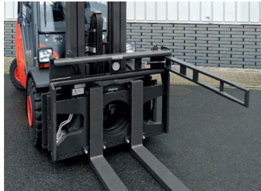
Drehgerät mit seitlichem Stützarm; manuell verstellbar, einklappbar und umsteckbar
